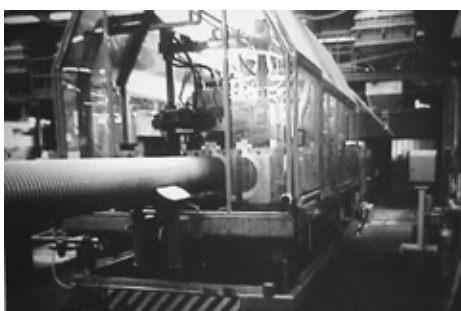
2. ábra: KD-EXTRA cső extrudálása
