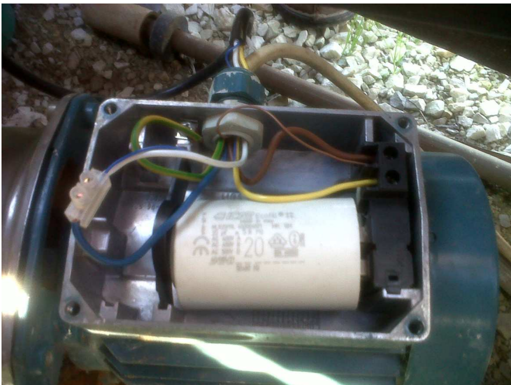
1 fázisú, felszíni szivattyú bekötése
