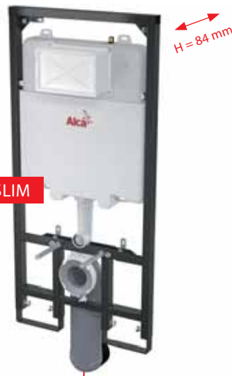
A1101/1200 Sádromodul Slim(vékony) falba építhető rendszer száraz szereléshez(gipszkarton vagy Slimbox)
